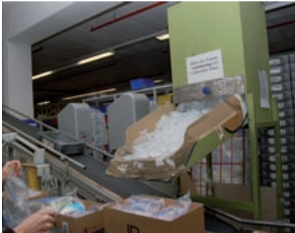
„On the fly“: Pakete mit Luftkissen auspolstern, Deckel drauf, Versandetikett aufkleben
