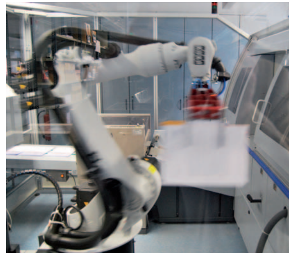
Heft kurz vor der Fertigstellung: Per Roboterarm gelangt der Stapel in die Klebmaschine.
