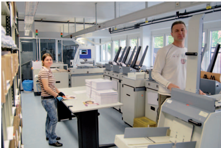
Vom Sammelsystem bis zur Klebmaschine: Produktionsstraße für individuelle Angebots-Hefte
